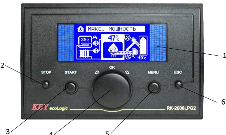
Рис. 4 Елементи управління регулятора серії KEY RK-2006\*\*\*\*.
